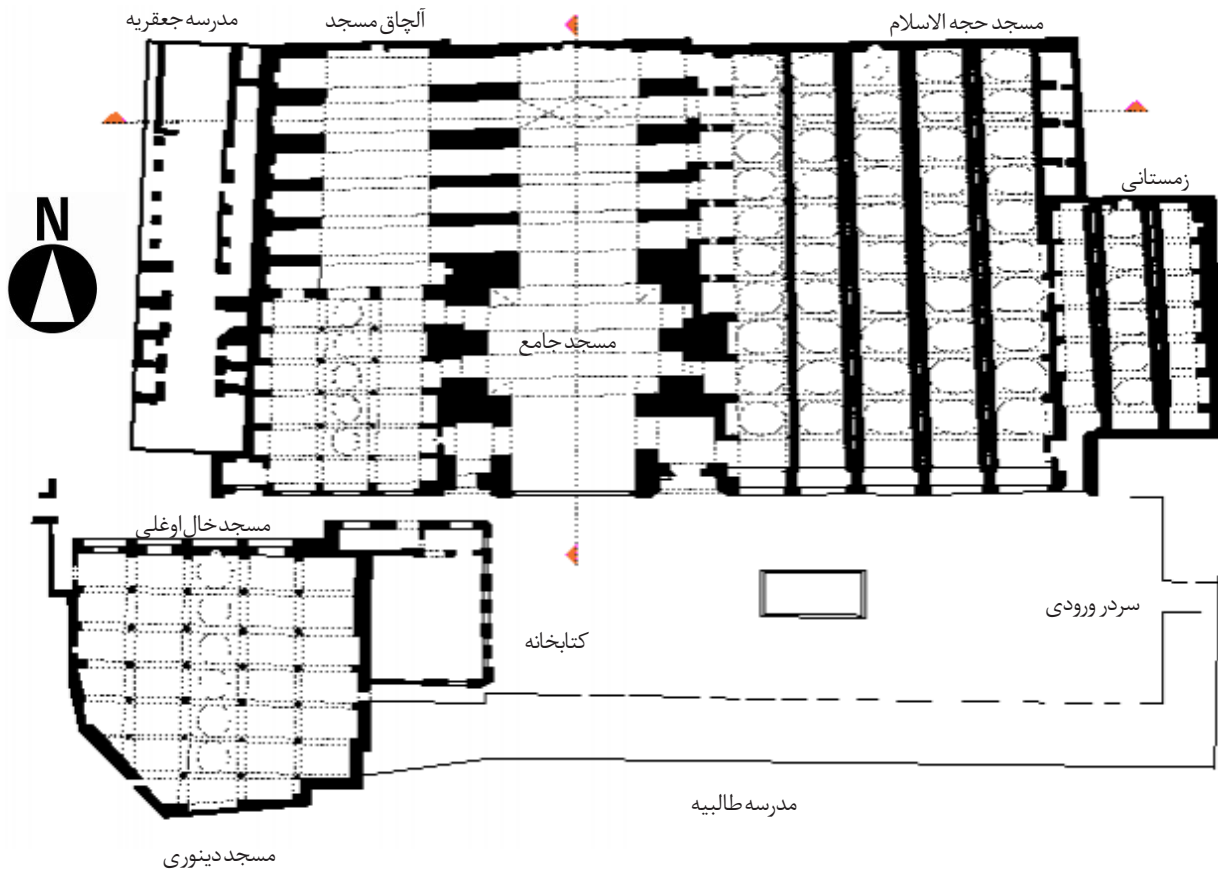
تصویر ۴. پلان وضع موجود مجموعه مسجد جامع کبیر تبریز. مأخذ: (آرشیو سازمان میراث فرهنگی، صنایع دستی و گردشگری استان آذربایجان شرقی)
