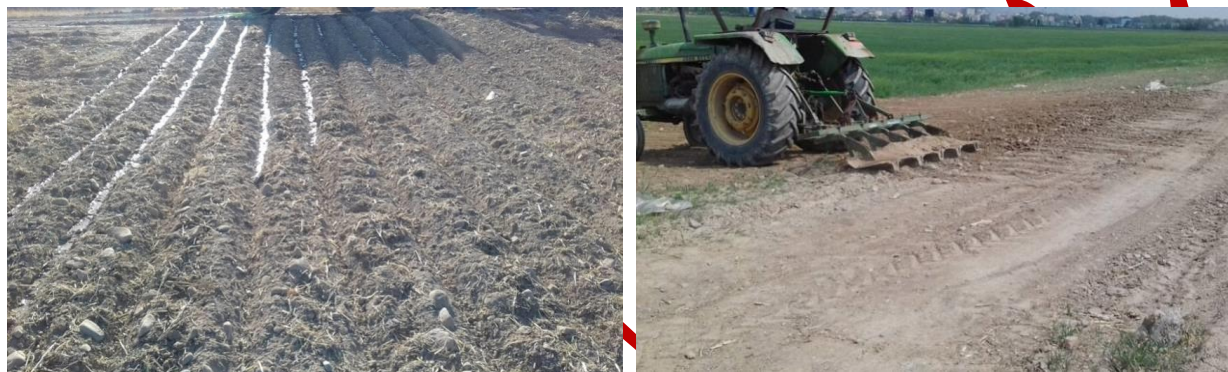
شکل ۱. نمایی از دستگاه شیار زن اتویی و شیارهای ایجاد شده
