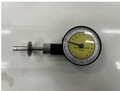
شکل ۲- دستگاه نفوذسنج مورد استفاده در آزمایش‌ها
