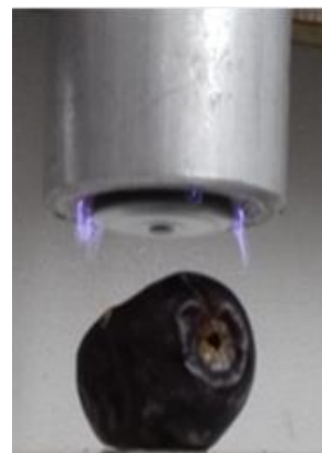
شکل ۲: نمونه در حال پلاسما دهی توسط راکتور قوس چرخشی لغزان حین پلاسما دهی
