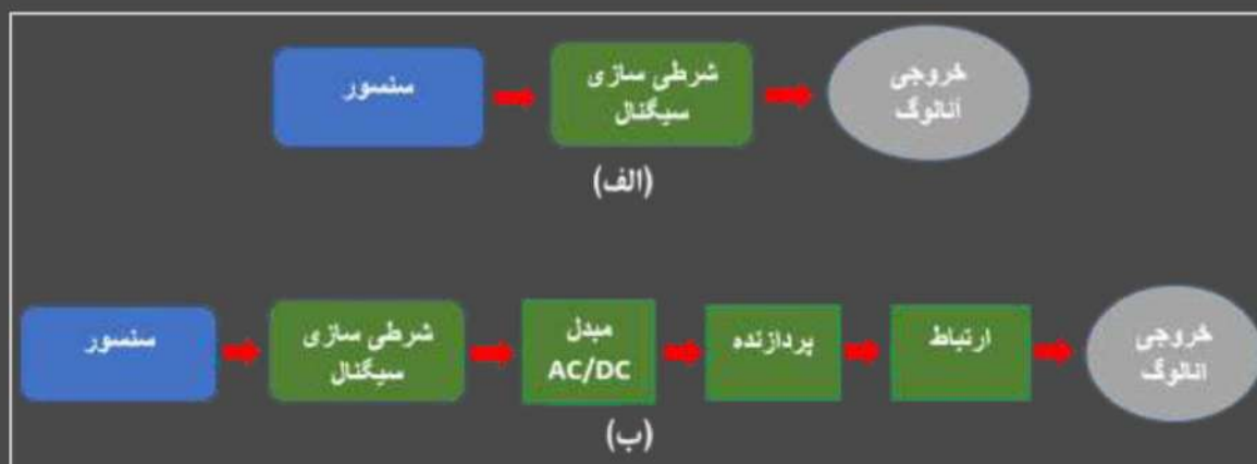
شکل ۱: (الف) سنسور پایه و (ب) سنسور هوشمند
