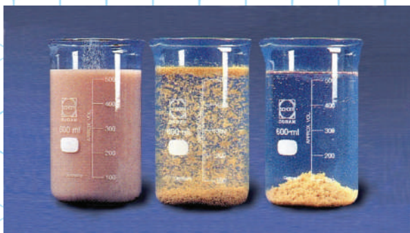
فرایند انعقاد و لخته شدن در تصفیه آب و پساب
