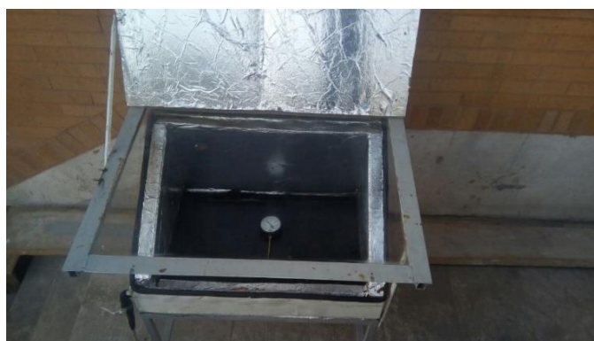
شکل ۱۰. محل استقرار دماسنج درون اجاق خورشیدی جعبه‌بزرگ
