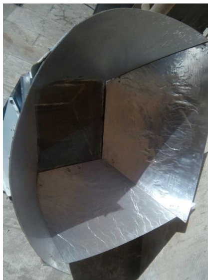
شکل ۸. اجاق خورشیدی مجهز به بازتابنده مخروطی
