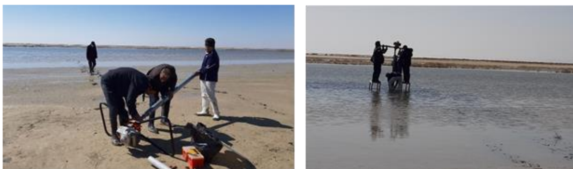
شکل ۲- تصاویری از بکارگیری آگر بنزینی با سیستم مغزه‌گیری چرخشی در زیرمحیط کانال منشعب در دلتای رودخانه زاینده‌رود
