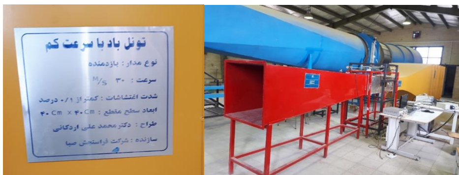
شکل شماره ۱. تونل باد مورد استفاده جهت اندازه‌گیری آستانه فرسایش بادی
