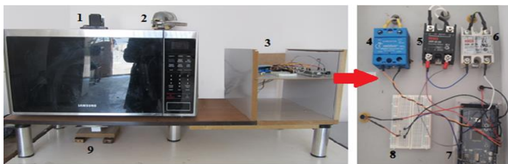
شکل ۱- نمایی از خشک کن مایکروویو- هوای گرم و اجزای آن (۱ دوربین، ۲ فن و هیتر، ۳ جعبه کنترل، ۴ رله SSR برای کنترل توان مایکروویو، ۵ رله SSR برای کنترل سرعت فن، ۶ رله SSR برای کنترل دمای هوای ورودی، ۷ برد آردوینو، ۸ برد بورد، ۹ لودسل
