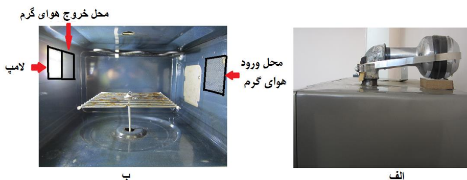
شکل ۳- الف) موقعیت نصب فن روی خشک‌کن مایکروویو- هوای گرم، ب) محل ورود و خروج هوای گرم به خشک‌کن مایکروویو- هوای گرم
