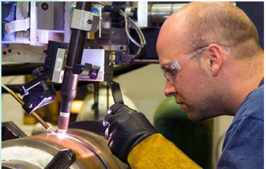
شکل ۴ - تصویری از یک مهندس جوشکاری در حال بررسی یک جوش ایجادشده به‌روش EBW
