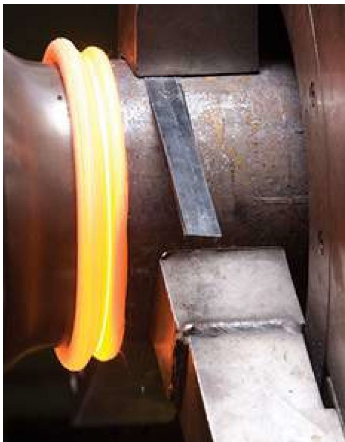
شکل ۳- روش جوشکاری اصطکاکی، از روش های جوشکاری غیرذوبی
