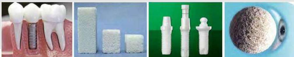
شکل ۲ - نمونه‌هایی از کاربرد مواد سرامیکی در پزشکی
