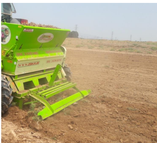
شکل ۳- تصویر کامل دستگاه پیازکار زعفران متصل به تراکتور و در حال کاشت پیاز زعفران
