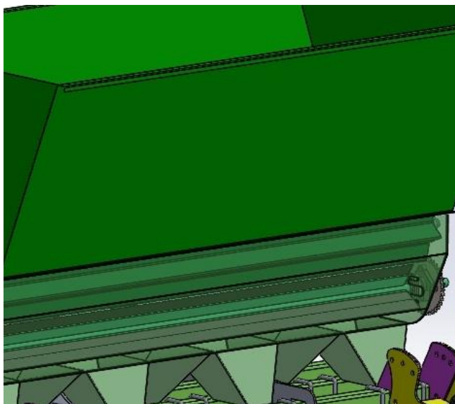
شکل ۲- نمای کامل سیستم موزع در زیر مخزن، شامل غلتک های شیاردار و استوانه جداکن و مجاری خروج پیاز زعفران
