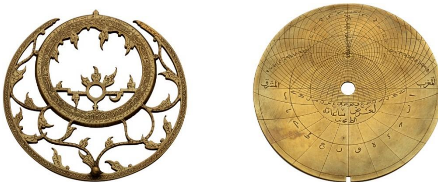
شکل ۲. صفيحه (راست) و عنکبوت (چپ) اسطرلاب معيار (ساخت عبدالأمنه، قرن ۱۲ق، اصفهان)؛ www.adlerplanetarium.org/collections/
