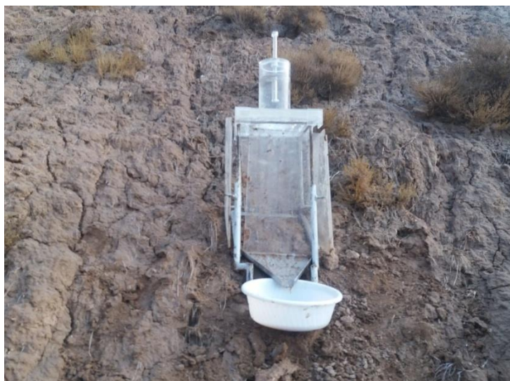
شکل ۵. دستگاه شبیه ساز باران (kampaHorst) برای اندازه گیری میزان رسوب، رواناب و نفوذ پذیری در هر یک از واحدهای کاری
