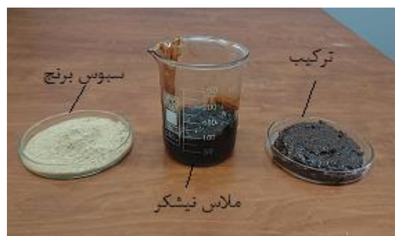
شکل ۱- مواد اولیه و ترکیب آنها برای ساخت پلت
