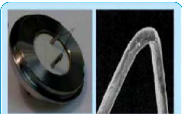
شکل ۴- تفنگ الکترونی با فیلامان تنگستی
