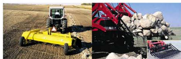
شکل ۶: نحوه کار سنگ جمع کن شانه ای
