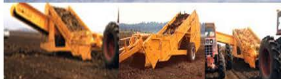
شکل ۸: نحوه کار سنگ جمع کن های تراکتوری کامل
