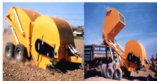
شکل ۹: مکانیسم تخلیه کن در سنگ جمع کن های تراکتوری کامل
