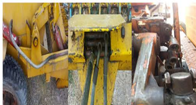
شکل ۱۰: مکانیسم اتصال به تراکتور در سنگ جمع کن های تراکتوری کامل
