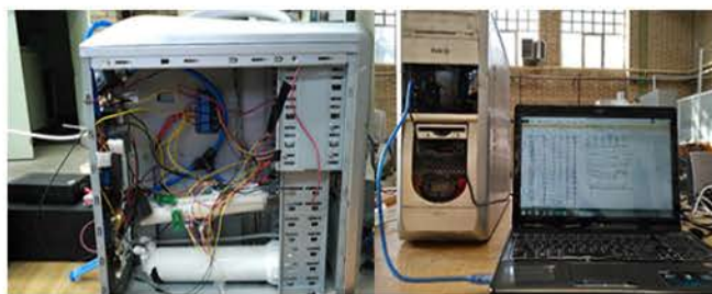
شکل ۲: نمای داخلی و نمای کلی سامانه ماشین‌بوایی ساخته شده در این تحقیق
