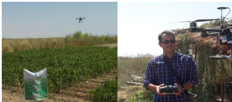
شکل ۳. تصویربرداری چندطیفی هوایی از مزرعه با پهپاد
