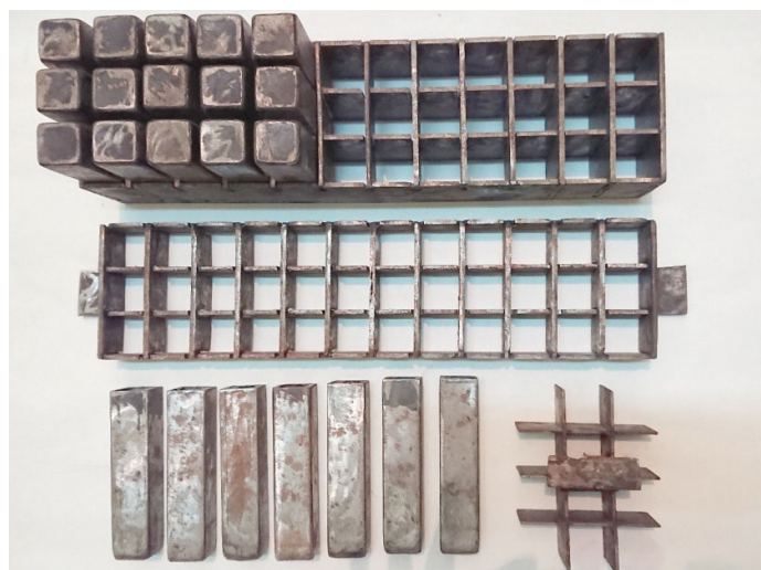
شکل ۱. ساختار قالب فلزی برای شکل دادن به لایه مغزی کاغذی
