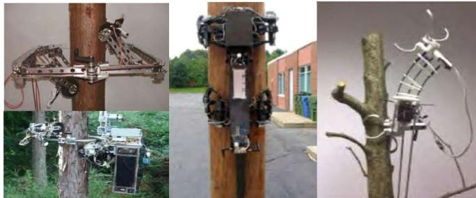
برای ربات‌های صعود‌کننده از تنۀ درخت سه نوع حرکت پیوسته، نیمه‌پیوسته و گسسته وجود دارد. در حال حاضر سه ساختار کلی برای حرکت ربات روی تنۀ درخت موجود است که استفاده از چرخ برای فشار به تنۀ درخت، طراحی ربات‌های الهام گرفته شده از طبیعت و استفاده از مکانیزم‌های مکانیکی را شامل می‌شود.
