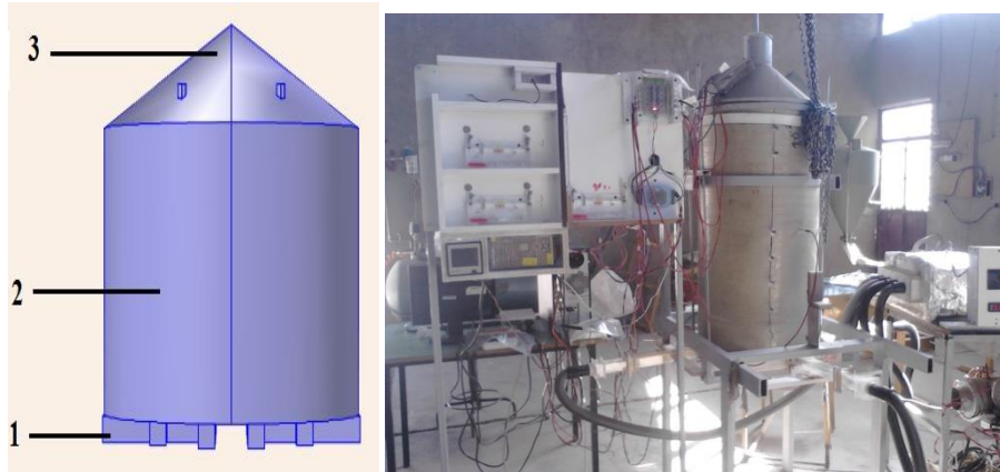
شکل ۳ - مخزن آزمایشگاهی مجهز به سیستم اندازه گیری (شکل سمت راست)، نواحی مختلف بستر شامل ۱-کانالهای ورودی، ۲-بستر حاوی مواد دانه‌ای و ۳-سقف (شکل سمت چپ)
