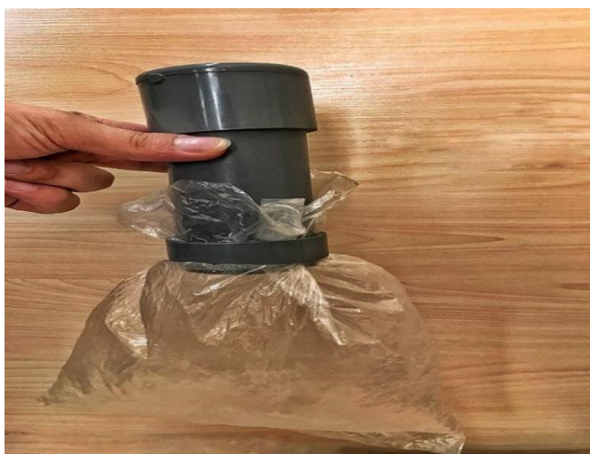
تصویر ۲. جمع آوری خاک صاف شده با استفاده از الک عمودی غربالگر.
