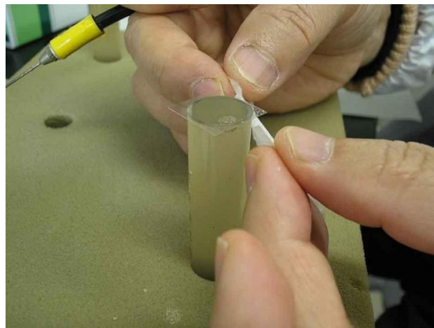
تصویر ۳. افزودن محلول ساکاروز و قرار دادن لامل بر روی لوله آزمایش.
