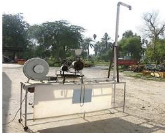
شکل ۱. سیستم انتقال نیوماتیک عمودی ذرت، (۱) الکتروموتور، (۲) دمنده، (۳) موتور موزع، (۴) موزع، (۵) مخزن موزع، (۶) فشارسنج، (۷) خم اول، (۸) خم دوم، (۹) خم سوم، (۱۰) لوله‌های انتقال، (۱۱) مانومتر
