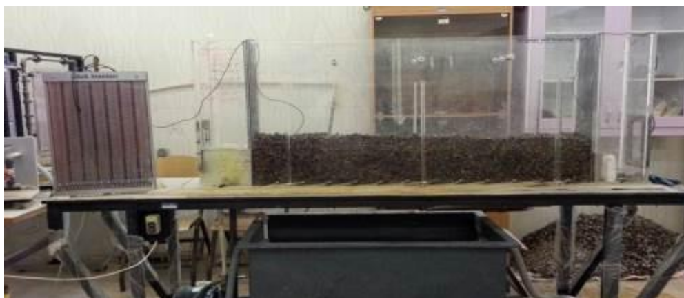
شکل ۱. فلوم و محیط متخلخل مورد استفاده در آزمایش
