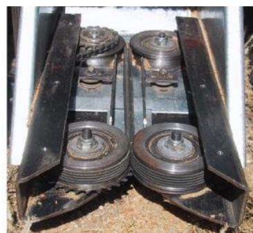
شکل ۱. مکانیزم تسمه و پولی
