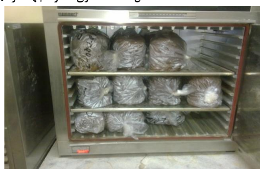
شکل ۴- نگهداری نمونه ها در حالت اشباع در ۴۰ درجه
