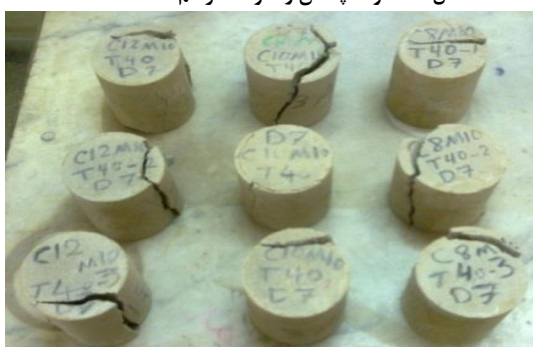
شکل ۵- نمونه های شکسته شده بعد از تعیین مقاومت فشاری
