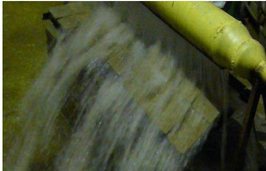
شکل ۶- نمایی از سازه جت آب صفحه‌ای و چیدمان نمونه‌ها در زیر آن
