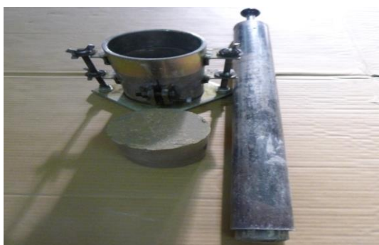
شکل ۳- مولد، چکش و نمونه متراکم شده
