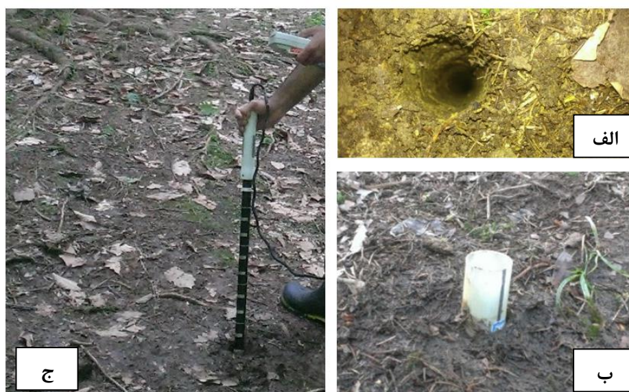
شکل ۱. الف) نمایی از چاهک حفر شده، ب) لوله دسترسی نصب شده، ج) رطوبت‌سنج PR2/6 در حال اندازه‌گیری رطوبت خاک
