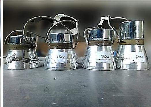
شکل ۲. ژنراتور توان بالای فراصوت (تصویر سمت چپ) به همراه مبدل‌های فراصوتی (تصویر سمت راست)
