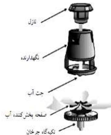
شکل ۲. نازل دوار صفحه آبی شرکت نلسون
