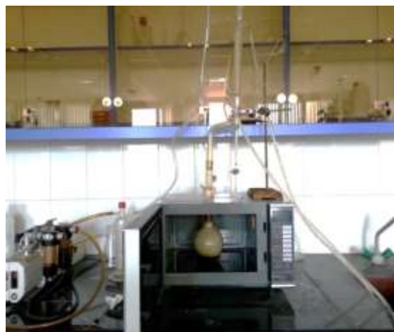
شکل ۱. دستگاه میکروویو تغییر شکل یافته مورد استفاده جهت تابش میکروویو به خاک
