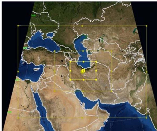
شکل ۶. سه حوزه محاسباتی اجرای مدل WRF. حوزه بیرونی دارای گام شبکه‌ای ۴۵ کیلومتر، حوزه میانی، ۱۵ کیلومتر و حوزه درونی، ۵ کیلومتر در هر دو راستای عرض و طول جغرافیایی است.
