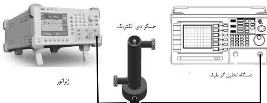
شکل ۲. طرحواره سامانه اندازه گیری و نحوه اتصال حسگر دی الکتریک
