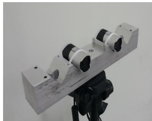
شکل ۵. دوربین استریو توسعه داده شده
