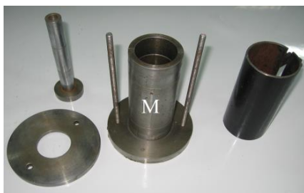
شکل ۱- قالب ویژه تهیه نمونه‌های آزمایشگاهی
