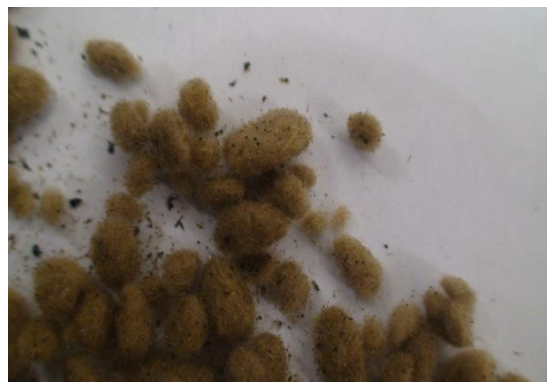
شکل ۱. الیاف پشم سنگ تهیه‌شده پیش از تمیزسازی
