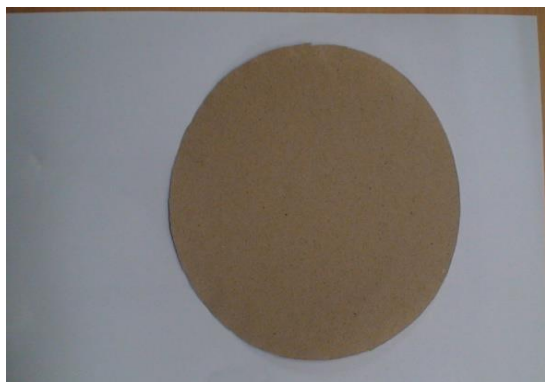
شکل ۲. کاغذ دست‌ساز حاوی الیاف معدنی
