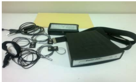
شکل ۱. دستگاه الکترومیوگرافی Biometrics. به همراه متعلقات آن
