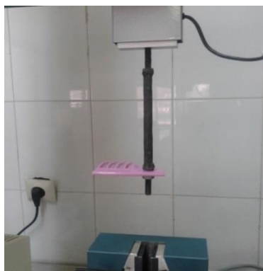
شکل ۱- اتصال ابزار ساخته شده به دستگاه آزمون مواد آزمون مواد برای انجام آزمایش.
