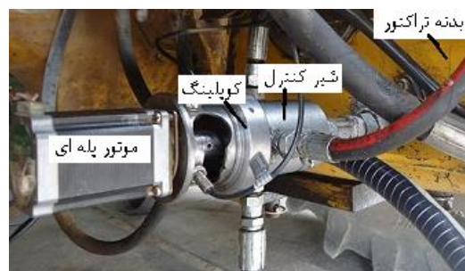
شکل ۲- شیر کنترل و موتور پله ای نصب شده بر روی تراکتور
