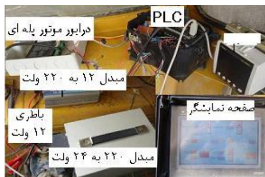
شکل ۳- اجزای واحد کنترل کننده سامانه الکتروهیدرولیکی.
