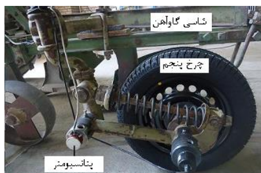
شکل ۴- مکانیزم حسگر عمق کار چرخ پنجم.
