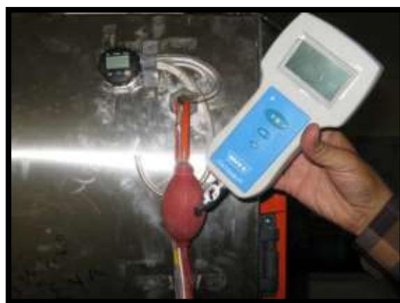
شکل ۵- دستگاه گاز آنالایزر، بالن لاستیکی و فشار سنج نصب شده بر روی بدنه سردخانه
