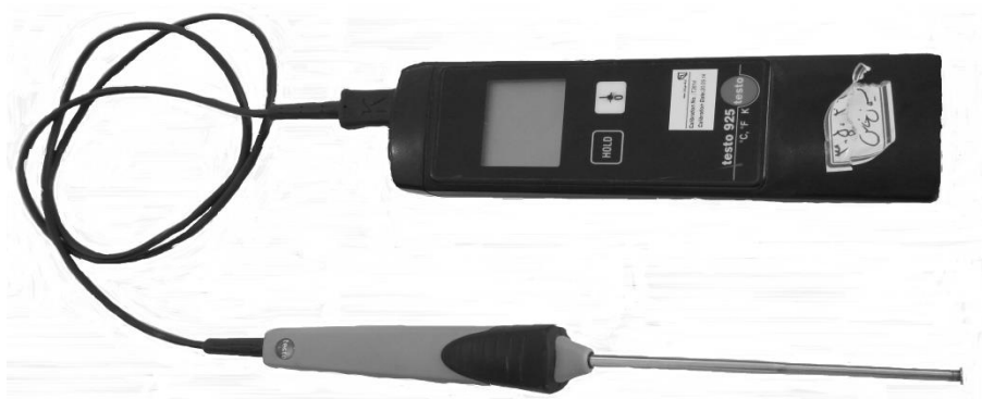
شکل ۶. ترموکوپل تماسی برای اندازه‌گیری دمای آفت
