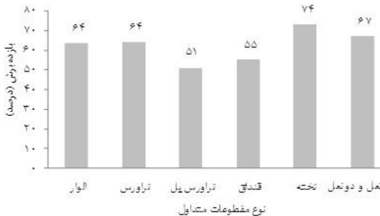
شکل ۴. نمودار مقایسه متوسط بازده‌های برش گرده‌بینه به صورت قامه کردن به چوب‌آلات متداول
