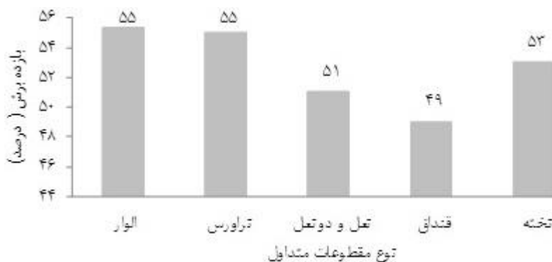
شکل ۳. مقایسه متوسط بازده‌های برش گرده‌بینه به صورت چهارتراش به چوب‌آلات متداول
