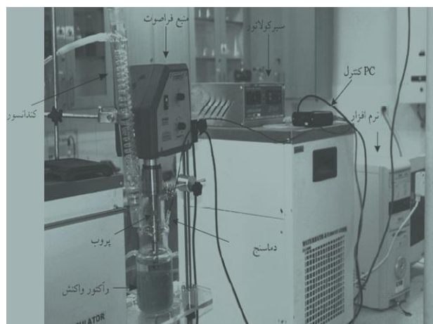
شکل ۱. سامانه تولید بیودیزل با استفاده از امواج فراصوت
