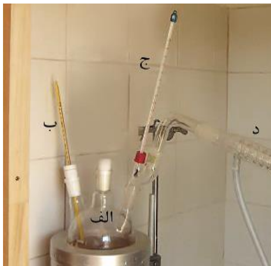
شکل ۳. ظرف واکنش (الف: محفظه واکنش، ب: دماسنج داخلی، ج: دماسنج گاز خروجی و د: چگالنده)
