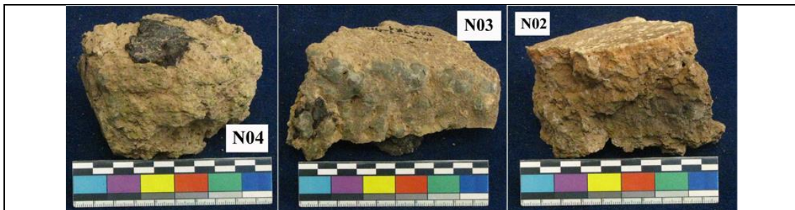
تصویر ۴. تعدادی از آجرهای مطالعاتی بدون لعاب که بقایای درجه حرارت بالا بصورت ساختارهای شیشه‌ای شده و تیره رنگ (جوش کوره) و اندوهدایی از جنس قیر بر روی سطح آن مشخص می‌باشد.
