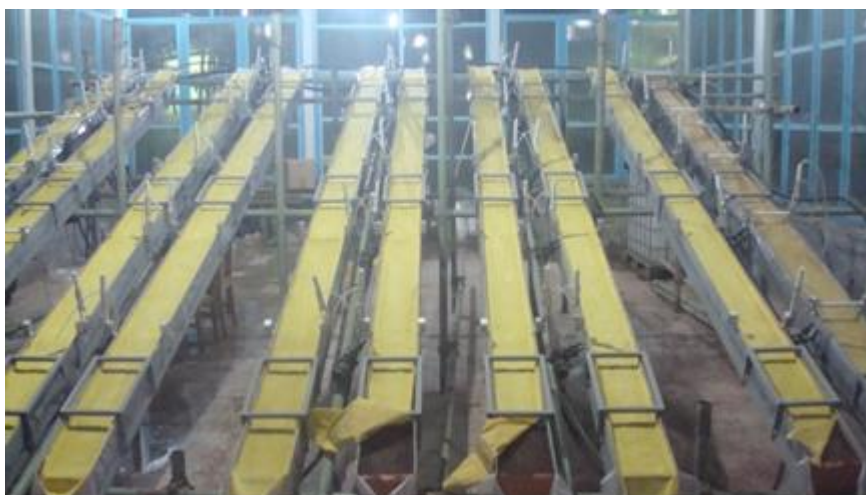
شکل ۱. تصویر و طرح شماتیکی از سیستم شبیه‌ساز دامنه
