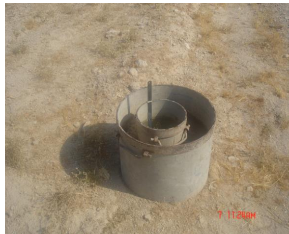
شکل ۳. طریقه نصب استوانه مضاعف به منظور اندازه‌گیری نفوذپذیری خاک
