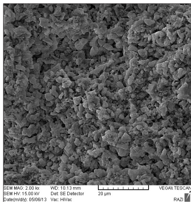
تصویر ۳۱ - عکس میکروسکوپ SEM از بافت سطحی ملات نمونه (بزرگنمایی ۱۰۰۰ برابر).
