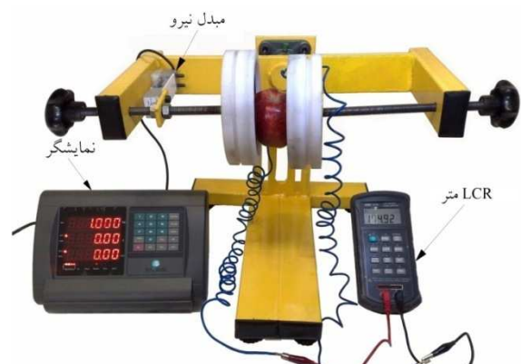
شکل ۱. دستگاه ساخته‌شده مجهز به مبدل نیرو برای اندازه‌گیری مقاومت الکتریکی میوه
