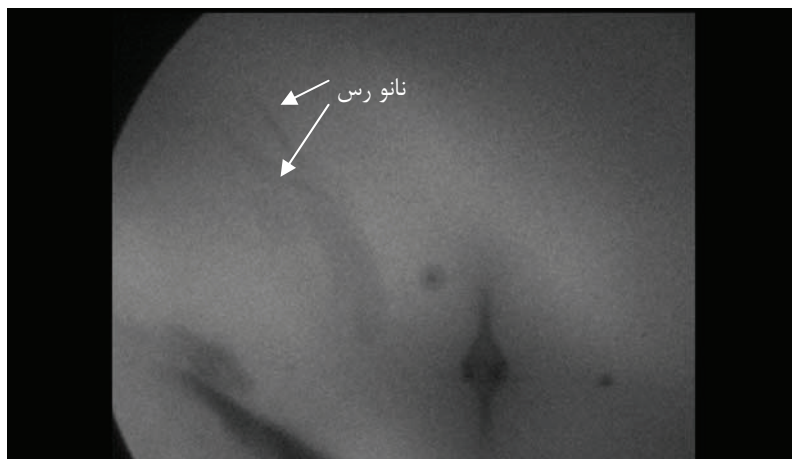
شکل ۵. تصویر میکروسکوپ الکترونی انتقالی نمونه‌های چندسازه چوب پلاستیکی با بزرگ‌نمایی ۱۵۰ نانومتر؛ نمونه حاوی ۳ درصد نانورس
